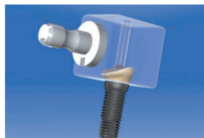
Fig. 12 Positionnement virtuel des vis de cicatrisation dans les blocs avant la réalisation de l'usinage.
